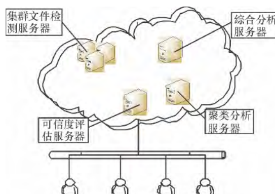
图2 基于可信计算的云入侵防御系统总体模型框架
